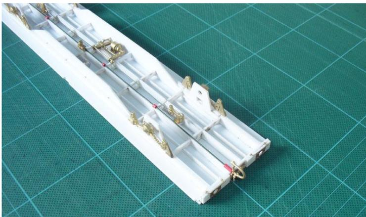
Weiter verbinden die Bremsgestänge (0.8 mm Draht) der Bremszylinder mit den Bremshebeln.
