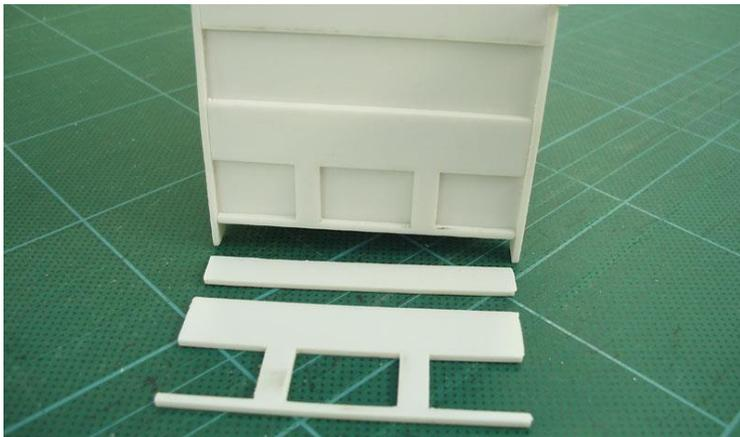
Für die Eck-Verstärkung wird die breiteste Seite eines Winkelprofils (6 x 3mm) ineinander geklebt mit einem Winkelprofil (3 x 3 mm).
